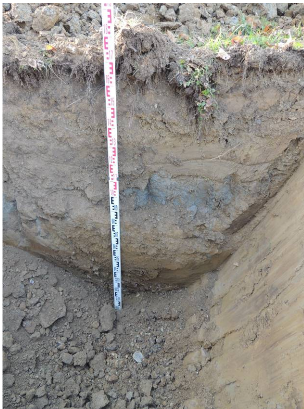
Dettaglio pozzetto esplorativo
