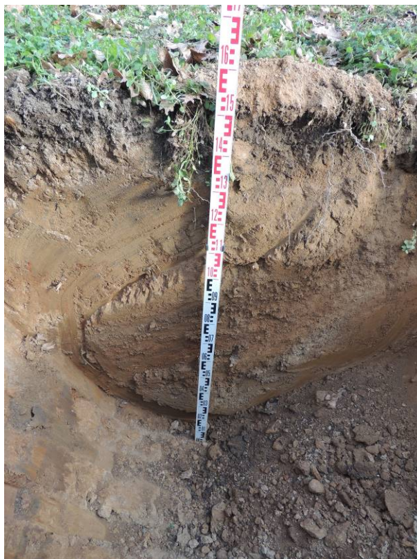
Dettaglio pozzetto esplorativo
