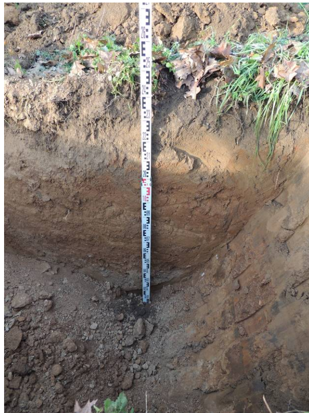
Dettaglio pozzetto esplorativo
