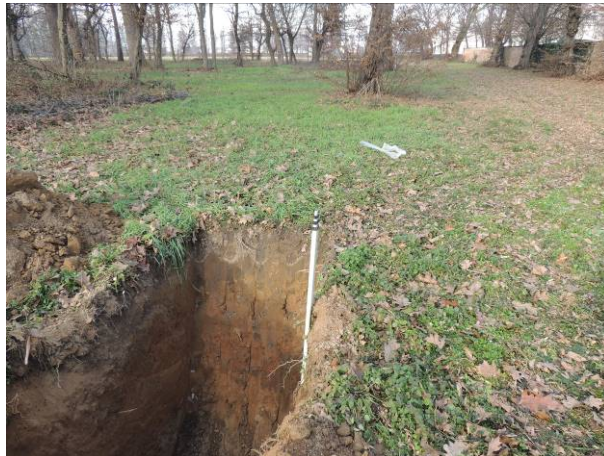
Dettaglio pozzetto esplorativo
